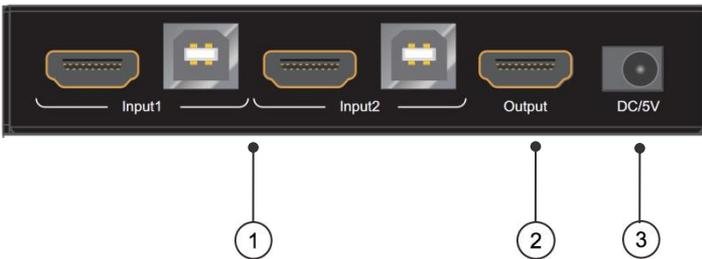
1) Inputs: 2x HDMI & 2x USB Type B
